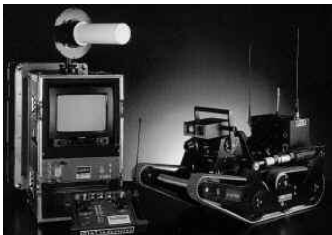
Рис.4.8 . Мобильный робот Castor (GIAT Industries, Франция) может иметь либо колесную, либо гусеничную ходовую часть.
