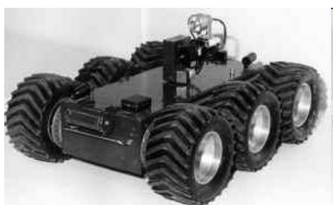
Рис 4.5 Сверхлегкий мобильный робот МРК-01 (МГТУ им. Н.Э. Баумана).
